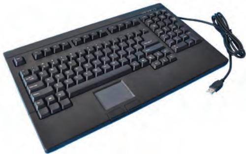
Ce clavier est un clavier d'ordinateur standard muni d'un pavé tactile supplémentaire. Il permet de saisir des données dans votre système d'affranchissement. Pour utiliser les touches numériques, vérifiez que **[Verr Num]** est activé. Vous pouvez utiliser les raccourcis indiqués dans le tableau ci-dessous
